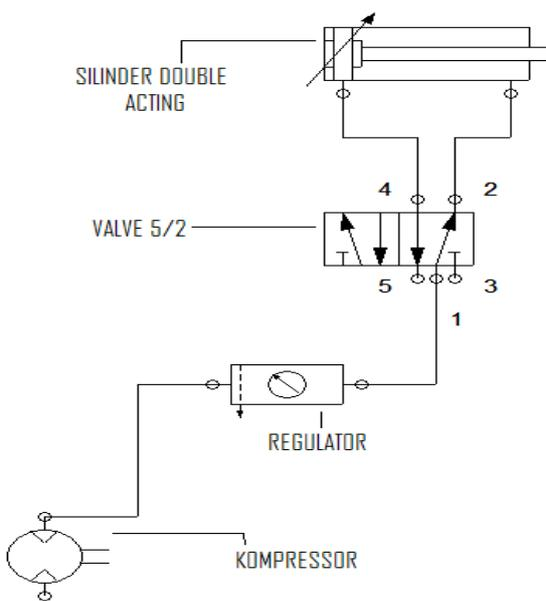
Gambar 4. Diagram Koneksi Silinder Pneu-
