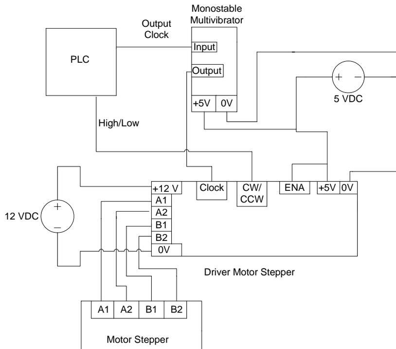
Gambar 10. Rangkaian Koneksi PLC dengan Driver Motor Stepper
