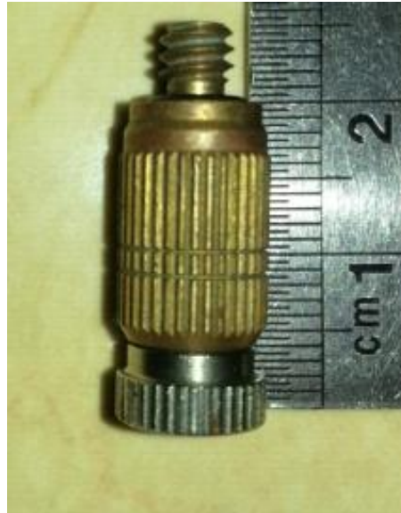
Gambar 4. Spraying nozzle yang digunakan pada dehumidifier tower .
