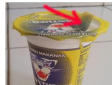
Gambar 2. Cacat Produk Seal / Tidak Merekat Sempurna atau Cup Bocor
