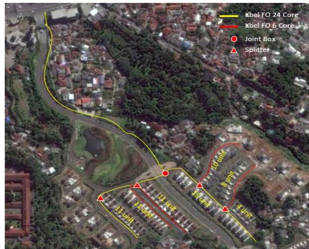
Gambar 3.6 Tampak lokasi dengan google earth untuk pemetaan kebutuhan kabel
