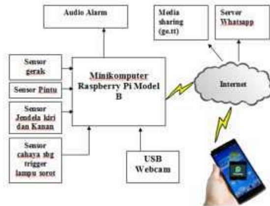
Gambar 3. Diagram Blok Sistem Keamanan Rumah berbasis Raspberry Pi
