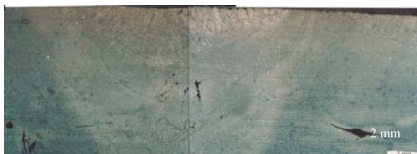
d). Foto struktur makro pada daerah yang terpengaruh panas, heat input 1,77 kJ/mm
