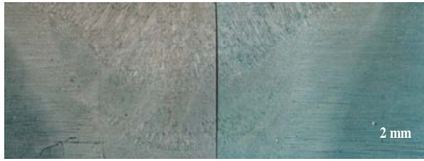
a). Foto struktur makro pada daerah yang terpengaruh panas, heat input 3,99 kJ/mm
