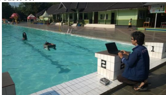
Gambar 11 Pengujian penghindaran halangan
