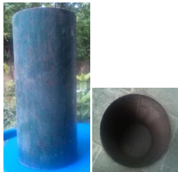
Gambar 2. Ring Infiltrrometer berdiameter 11 cm dan tinggi 25 cm
