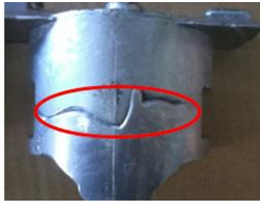
Gambar 9. Cacat pertemuan dingin pada temperatur cetakan 250°C
