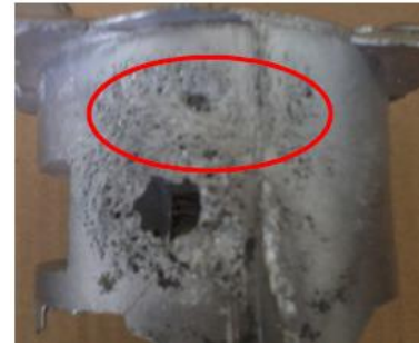
Gambar 14. Permukaan kasar pada temperatur cetakan 250°C
