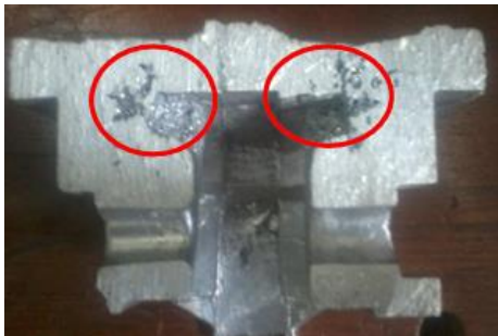
Gambar 10. Shrinkage pada temperatur cetakan 250°C
