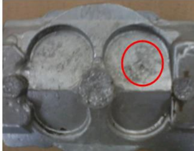
Gambar 19. Porositas pada temperatur cetakan 320°C
