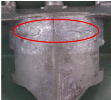
Gambar 16. Permukaan kasar pada temperatur cetakan 350°C
