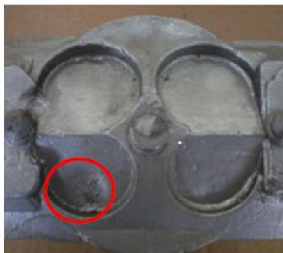
Gambar 20. Porositas pada temperatur cetakan 350°C
