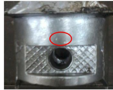
Gambar 17. Permukaan kasar pada temperatur cetakan 400°C
