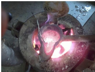
Gambar 7. Proses peleburan menggunakan tungku krusibel
