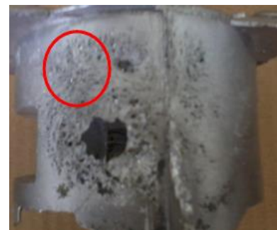
Gambar 18. Porositas pada temperatur cetakan 250°C
