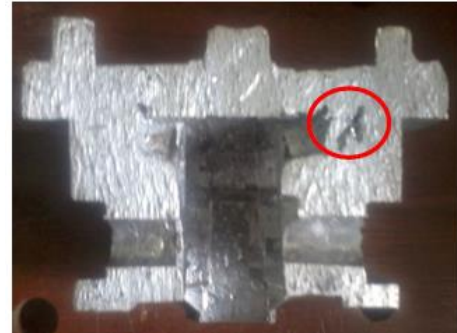
Gambar 11. Shrinkage pada temperatur cetakan 320°C
