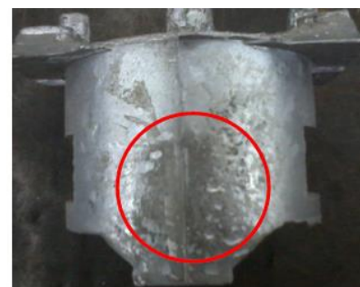
Gambar 15. Permukaan kasar pada temperatur cetakan 320°C
