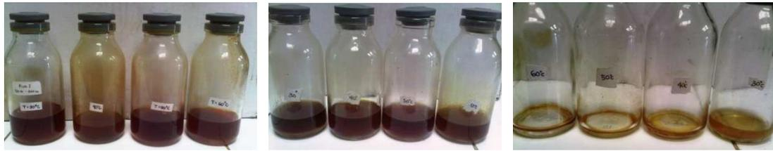
Gambar 3. Oleoresin jahe hasil penelitian dengan variabel pelarut (etanol, n-hexane dan acetone) dan suhu (30°C, 40°C, 50°C, dan 60°C).
