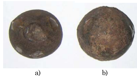
Gambar 2. Ball Mill a) \phi 30 mm b) \phi 40 mm
