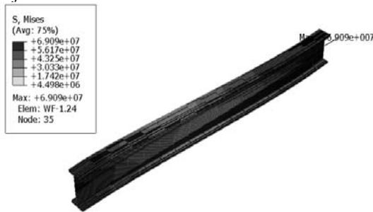
**Gambar 15.** Lokasi tegangan maksimum baja dengan lapisan fireproofing CAFCO300 tebal 10 mm
