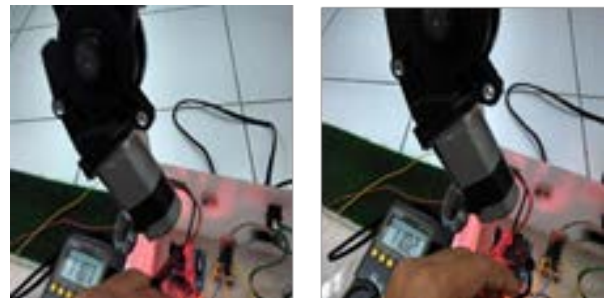
Gambar 9. Pengukuran hasil output putar kanan (kanan) dan output driver putar kiri (kiri)
