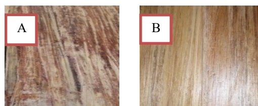
Gambar 1. Keragaan permukaan papan zephyr tanpa finishing (A) dan setelah diberi lapisan finishing (B)
