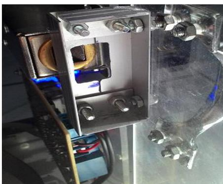
Gambar 8. Solenoid (on) membuka pengunci pintu
