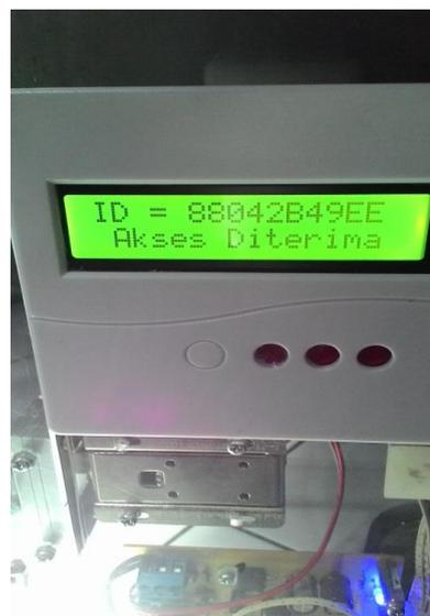
Gambar 9. Tampilan nomor ID E-KTP pada LCD 16x2
