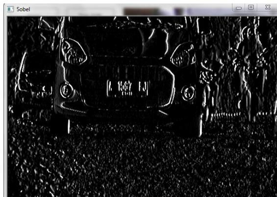
Gambar 5 hasil deteksi tepi menggunakan Metode Sobel
