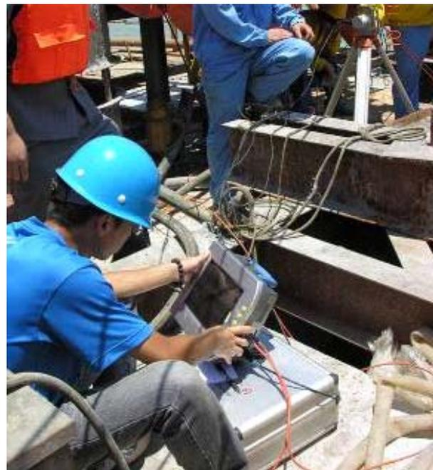
Gambar 12. Pipa grouting dan pelaksanaan Sonic Logging Test
