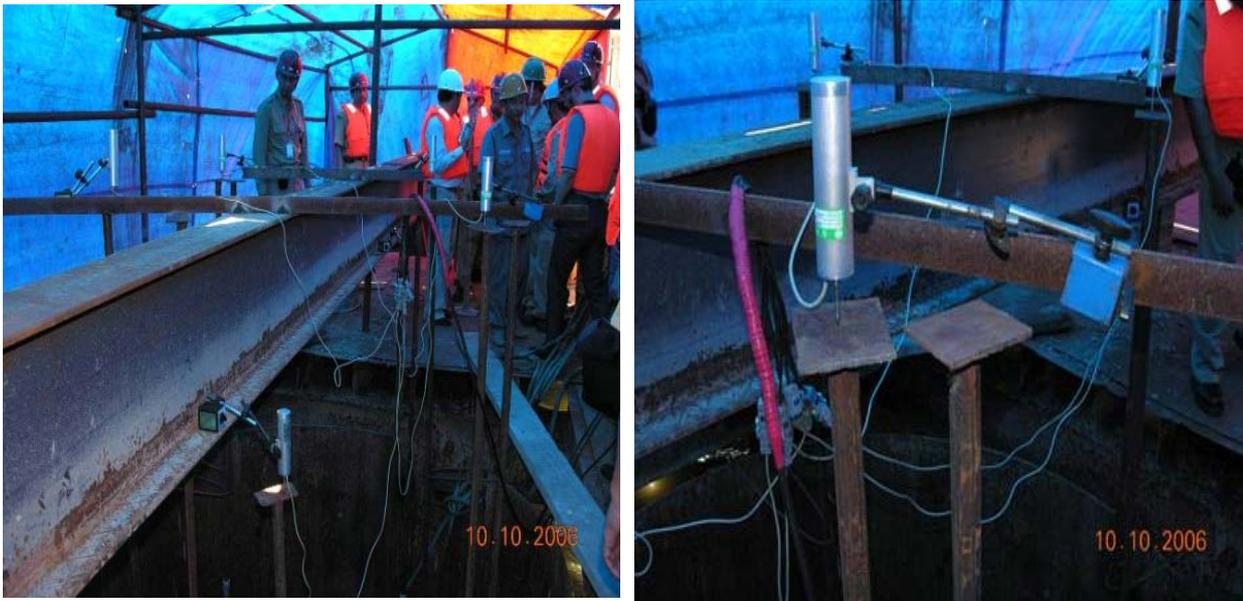
Gambar 15. Proses pelaksanaan Tes OC pada pondasi Jembatan Suramadu
