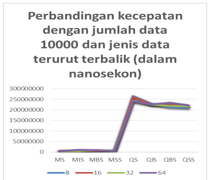
Gambar 8. Perbandingan kecepatan kandidat algoritma dengan jumlah data 10000 dan jenis data terurut terbalik.
