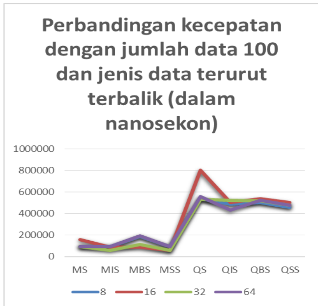
Gambar 6. Perbandingan kecepatan kandidat algoritma dengan jumlah data 100 dan jenis data terurut terbalik.
