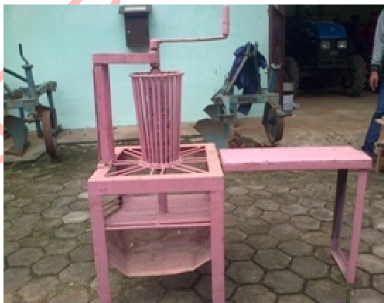
Gambar 4. Alat pemipil jagung semi mekanis hasil modifikasi
