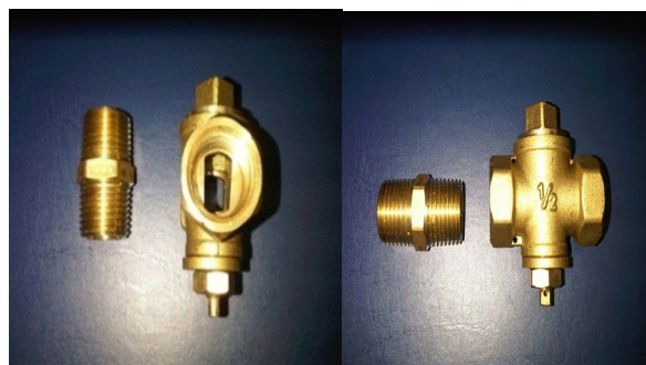
Gambar 2. Plug Valve yang digunakan dalam Penelitian Solenoid Valve
