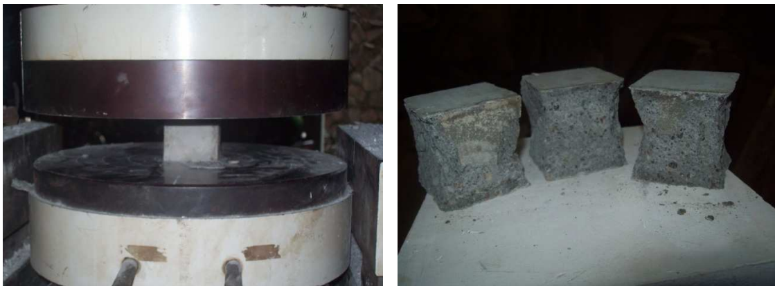
Gambar 1.5 Uji Tekan Mortar
