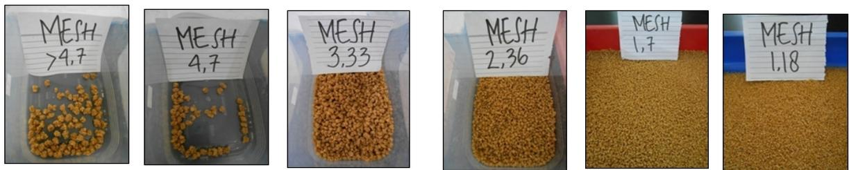
Gambar 1. Butiran beras analog dengan ukuran mesh.
