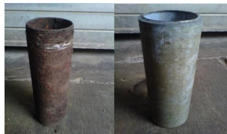
Gambar 2. Pipa korosi dan Pipa baru
