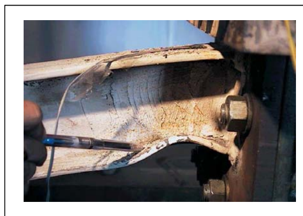
Gambar 13. Tekuk lokal pada sayap bawah
