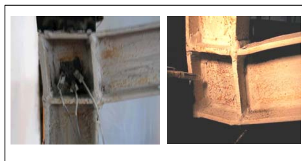
Gambar 14. Deformasi geser pada sambungan balok dan kolom
