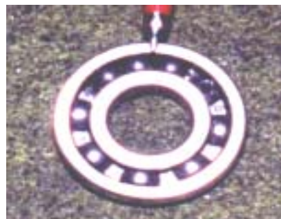
Gambar 22. Foto Kerusakan pada Pemisah
