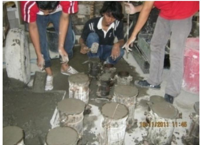
Gambar 2. Proses pencetakan benda uji beton
