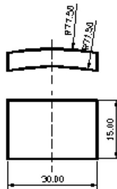
Gambar 6. Spesimen Uji
