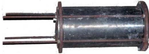
Gambar 5. Cetakan Logam
