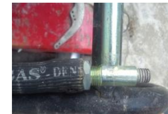
Gambar 4. Sambungan selang dari leher karburator ke stick kompor gas dan sambungan selang dari stick kompor ke regulator high pressure .
