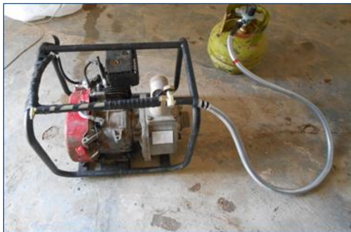
Gambar 5. Hasil akhir modifikasi pompa
