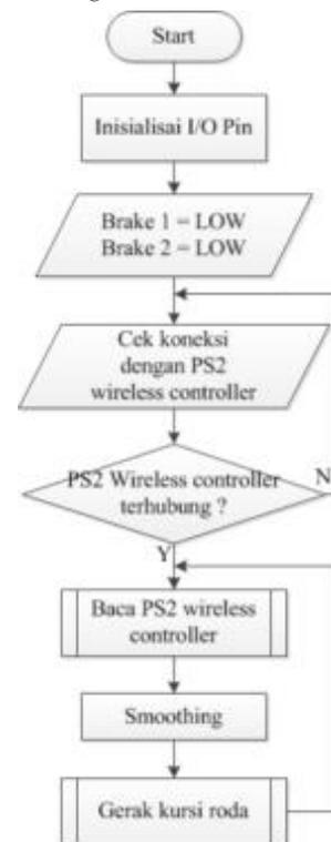
Gambar 6. Flowchart alat pengendali kursi roda elektrik
