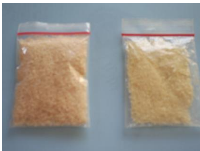
Gambar 4. Khitosan yang dihasilkan dari kulit udang dan rajungan
