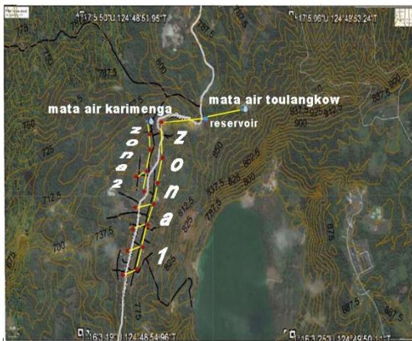
Gambar 3. Skema Perencanaan Sistem Jaringan Perpipaan
