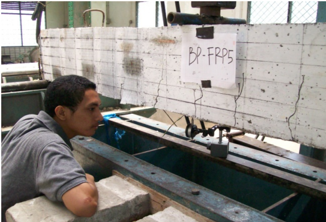
Gambar 10. Posisi pembebanan terpusat pada pengujian balok BP1-FRP5
