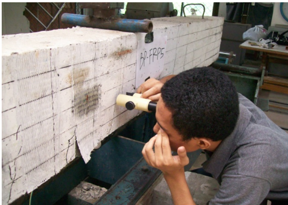
Gambar 11. Pengukuran lebar retak dengan menggunakan microcrack tester
