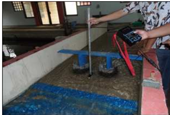
Gambar 4. Pengukuran Debit Banjir dengan Menggunakan Current Meter.
