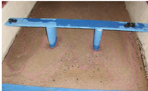
Gambar 5. Pola Gerusan yang Terjadi Pada Pilar Tanpa Pengaman.
