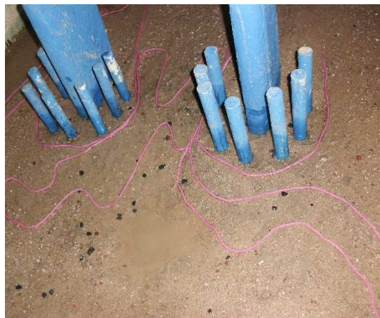
Gambar 7. Pola Gerusan yang Terjadi Pada Pilar Dengan Pengaman Bored Pile.
