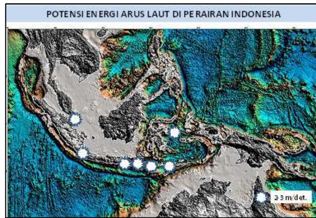
Gambar 1. Peta potensi energi arus laut di Indonesia. Tanda bintang putih menunjukkan lokasi kecepatan arus antara 2-3 m/s. (Sumber: PPPGL)
