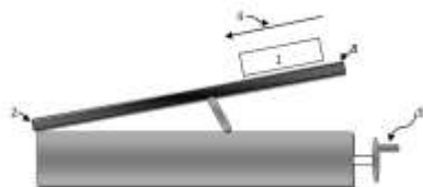
Gambar 7. Sketsa alat pengujian koefisien gesek bidang miring.
