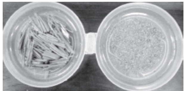
Gambar 10. Hasil pengeringan kulit lidah buaya menggunakan microwave, 80 Watt
