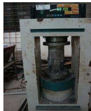
Gambar 7. Pengujian Kuat Tekan Silinder Beton
