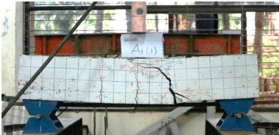
Gambar 13. Pola Retak Benda Uji A1
