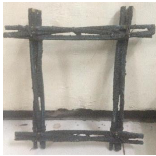
Gambar 3. Tulangan Bambu yang Sudah Dilapisi dan Dibentuk Sengkang
