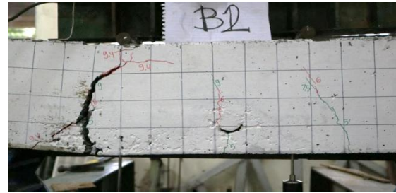
Gambar 16. Pola Retak Benda Uji B2
