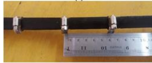
Gambar 3. Pemasangan kait klem selang pada tulangan bambu.
