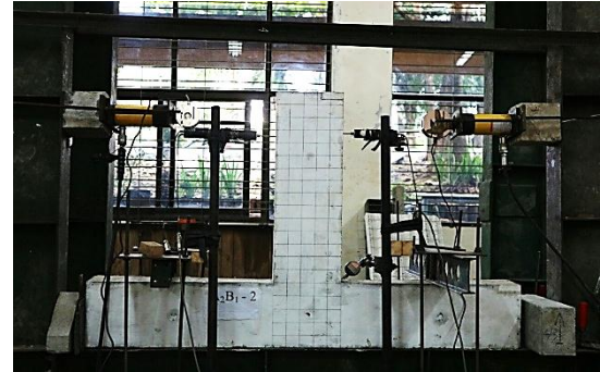
Gambar 8. Pemodelan beban lateral dua arah.
