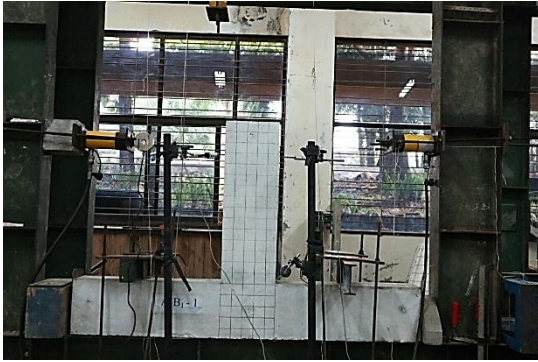
Gambar 6. Pemodelan beban Lateral Satu Arah.
