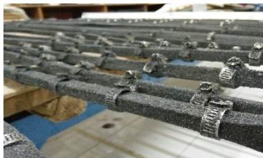
Gambar 2. Hasil pemberian lapisan pada tulangan bambu.
