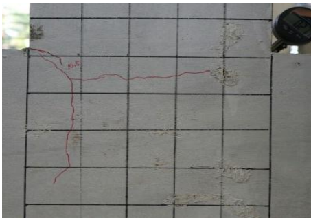
Gambar 11. Pola retak balok A_1B_1 -1.
