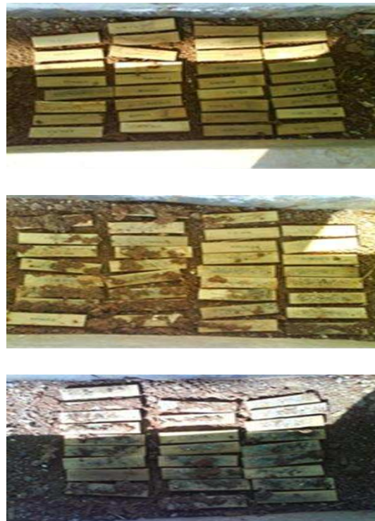
Gambar 4. Kondisi pengujian rayap dan serangan rayap tanah terhadap benda uji
