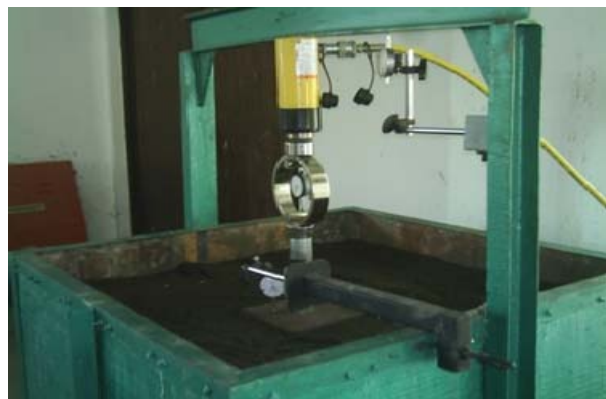
Gambar 1. Setup pengujian model fondasi
