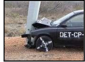
Gambar 5. Tiang utilitas dan mobil mengalami kerusakan
