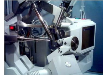
Gambar 5. Difraksi sinar X menggunakan Difraktometer Cu source .
