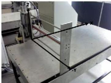
Gambar 5 Prototipe Mesin CNC
