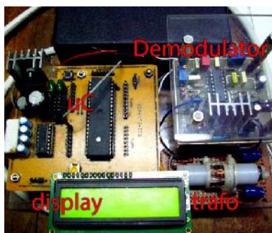
Gambar9. Perangkat Receiver yang terdiri dari demodulator PLC, mikrokontroler dan trafo kopling
