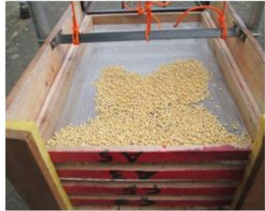
Gambar 10. Rak dengan bahan (keripik singkong) yang telah masuk dan tersusun dalam boks dan rak dengan bahan (kedelai) yang menumpuk pada bagian depan rak.
