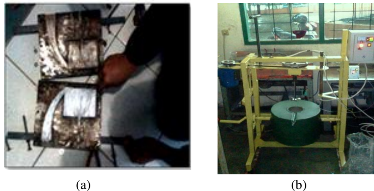
Gambar 2. (a) Hasil pengecoran (b) Mesin stir casting
