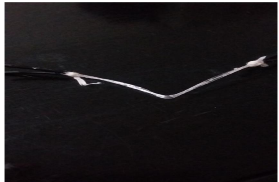
Gambar 10. Fabrikasi directional coupler konfigurasi 2x2 pada suhu 150^{\circ}\text{C} dan lama pemanasan 15 menit dengan serat optik dike-pang
