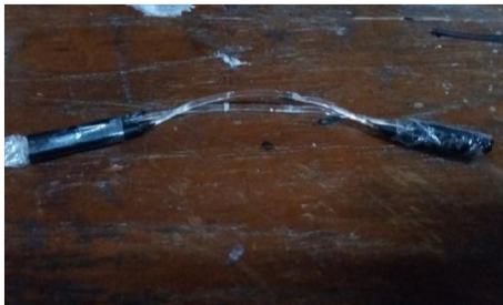
Gambar 8. Fabrikasi directional coupler konfigurasi 2x2 pada suhu 120^{\circ}\text{C} dan lama pemanasan 15 menit
