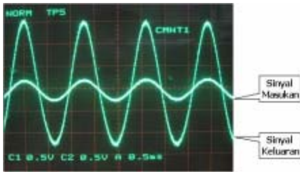
Gambar 22. Bentuk sinyal masukan dan keluaran penguat cascade CG-CG
