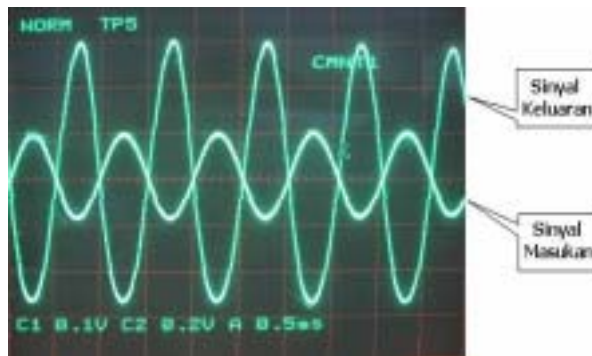
Gambar 18. Bentuk sinyal masukan dan keluaran penguat cascade CG-CS
