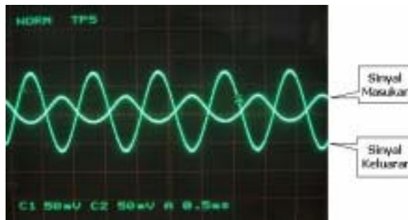
Gambar 12. Bentuk sinyal masukan dan keluaran penguat cascade CD-CS
