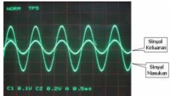
Gambar 14. Bentuk sinyal masukan dan keluaran penguat cascade CD-CD
