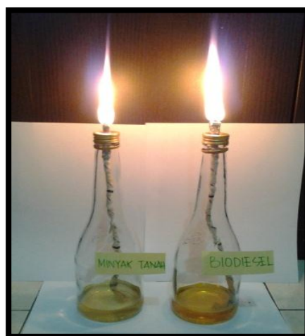
Gambar 5. Nyala api minyak tanah dan biodiesel yang diproses pada suhu reaksi 45°C dan waktu reaksi 5 menit
